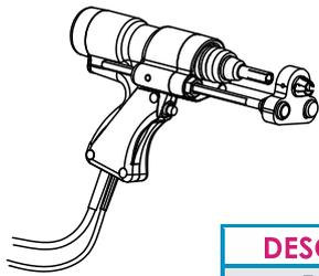
La soldadura de Pernos o Espárragos es un proceso especializado de soldadura con arco eléctrico que une pernos o componentes similares a una pieza base (normalmente una chapa). Muy usado en construcciones estructurales de acero, navales y en automoción. Tipos de soldadura:
